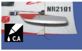
将三角型安装纸垫按图折叠好,用瞬间胶粘接到机身上。然后将钢丝尾架与木制垫块组装到一起,用瞬间胶粘接到机身上。
