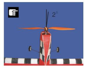
用电钻开好木制电机安装板上的安装孔,然后用瞬间胶将安装板粘接到机身上。安装电机。注意保持电机安装角下拉0°,右拉2°。
