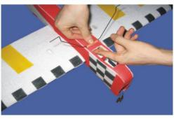
用瞬间胶将起落架固定到木制起落架安装板(如图)。再用刀片在机身底面切出一小段切口,将起落架和木制安装板组合插入到机身底面切口内(如图)。
