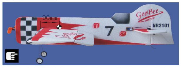
飞机的重心位于机翼前缘后部90mm处(见图)。可通过调整电池,接收机和调速器位置进行调整。
