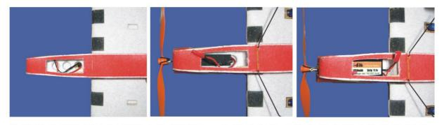
在机身前底面用小刀切出电池安装口,将用于固定电池的黑色魔术贴粘贴到机身内(见图),用于方便固定电池。
