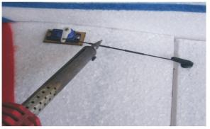
用刀片切去舵角的支柱,再将舵角用瞬间胶粘接到升降舵上加强碳纤片上,注意舵角与舵机连线保持与机身平行。安装操纵钢丝,通过热缩套管连接成一体。
