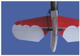
将舵角安装到方向舵上,注意舵角与舵机连线保持与平尾平行,用瞬间胶加强。安装操纵钢丝,通过热缩套管连接成一体。
