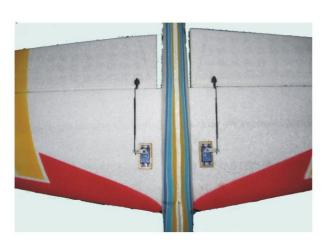
将舵角安装到副翼上,注意舵角与舵机连线保持与机身平行,用瞬间胶加强。安装操纵钢丝,通过热缩套管连接成一体。
