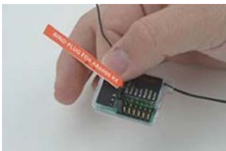
Mottakeren. Vekt 7 gram. Her vist med programmeringsplugg.
