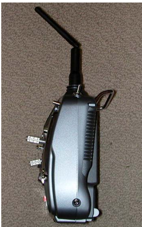
Senderen sett fra siden. Ladeplugg nederst. Antennen er vist i sin fulle lengde.
